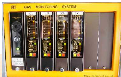
多点用壁掛式 最大実装6点まで
